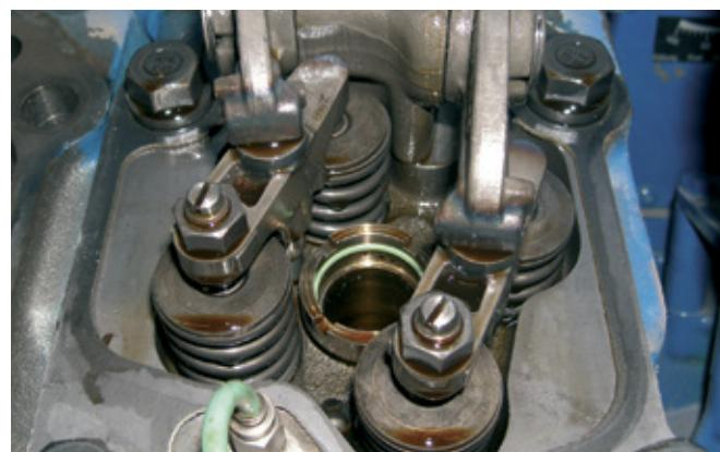
Клапанный механизм — MWM TCG 2016 V12
