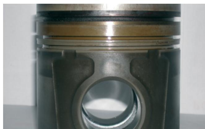
Поршень с кольцевыми канавками — MWM TCG 2016 V12
